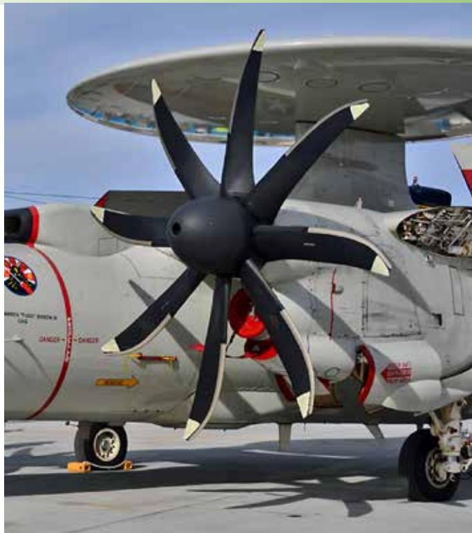
tien, ce qui réduit de 50 % le temps de maintenance courant sur avion et d'autant également le coût d'entretien à l'heure de vol. Enfin, en cas d'endommagement sur des terrains sommaires ou par des impacts, une pale composite peut être remplacée individuellement, sans changer le système complet.
