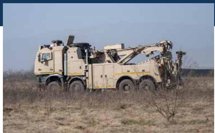
de conception Mercedes que Soframe adaptent profondément afin d'intégrer des équipements de mission (grue, treuil, remorquage), des solutions de protection passive, des moyens C3I et des systèmes d'autoprotection et de défense rapprochée. Aurus et Taurus, qualifiés et produits en série, enrichissent l'offre commerciale export du constructeur alsacien. ■
